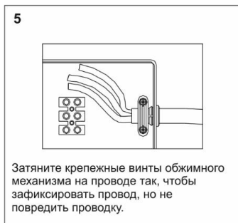
Рис.4 Подключение кабеля питания
