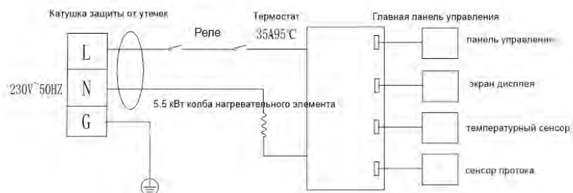
Рис.5 Электрическая схема для модели мощностью 5500 Вт.
