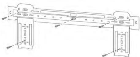
Рис.5 Монтажная пластина
