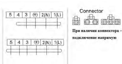
Рис. 20 Подключение внутреннего блока. Данная инструкция включает себя общие схемы на разные типы кондиционеров Thermex.
