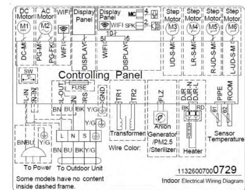
Рис. 23 Электрическая схема для внутренних блоков мощностью 9 000, 12 000, 18 000, 24 000 BTU, переводы см. таблицы 9-10.
