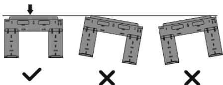
**Рис.6 Правильное расположение монтажной панели**
