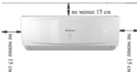
Рис.4 Определение места для установки внутреннего блока.
