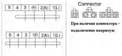
**Рис. 20 Подключение внутреннего блока.** Данная инструкция включает себя общие схемы на разные типы кондиционеров Thermex.
