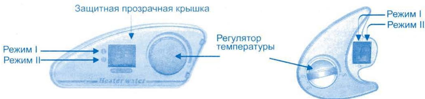
**Рис. 3. Механическая панель управления**
