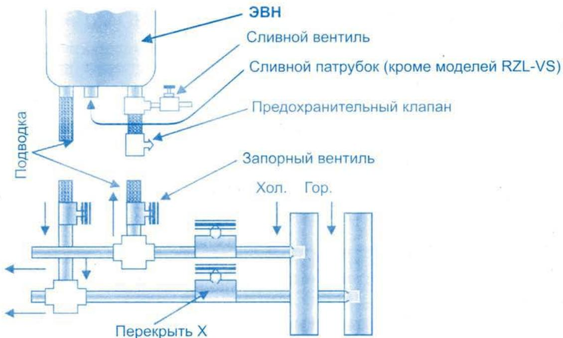
**Рис. 1. Схема подключения ЭВН к водопроводу**
