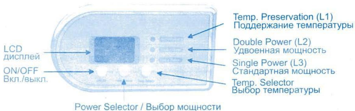
**Рис. 4. Электронная панель управления**
