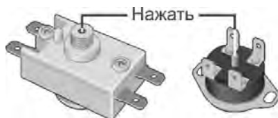
Рисунок 3. Возможные схемы расположения кнопки термовыключателя
