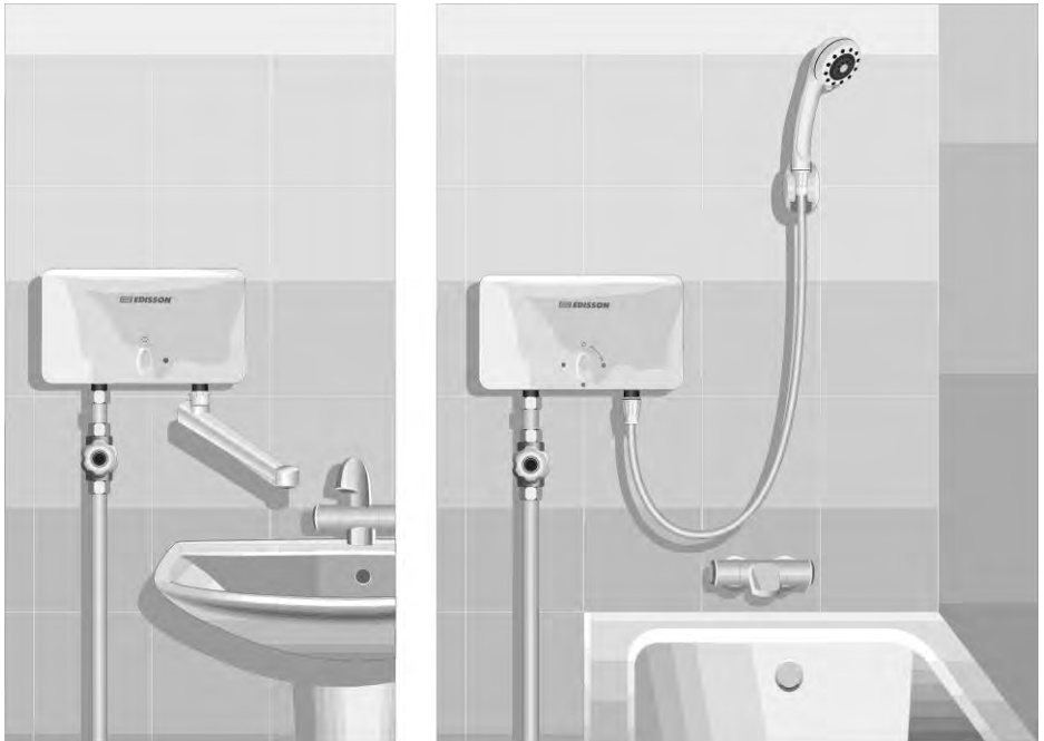
Рис 1. Установка ПЭВН EDISSON Viva
