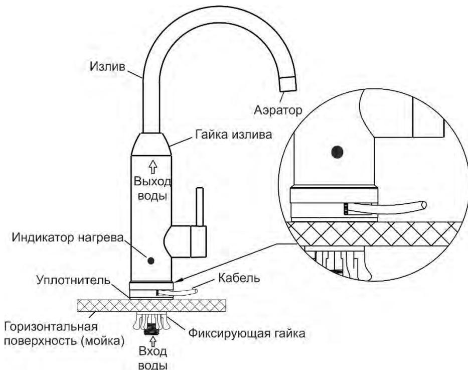
Рис. 1. Установка с выводом кабеля питания над мойкой
