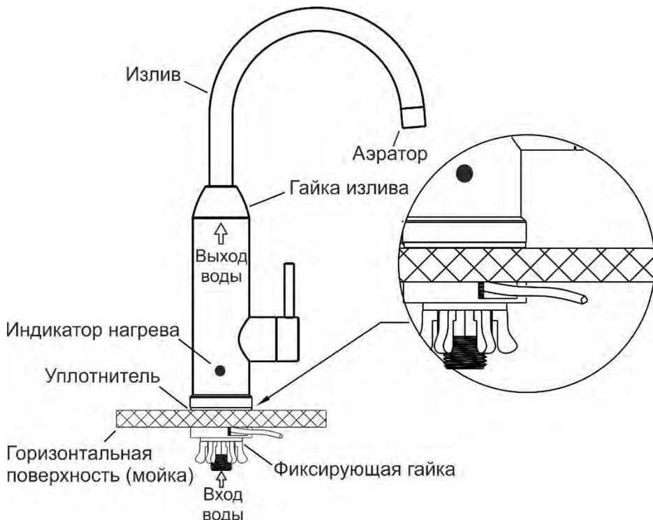
Рис. 2. Установка с выводом кабеля питания под мойкой
