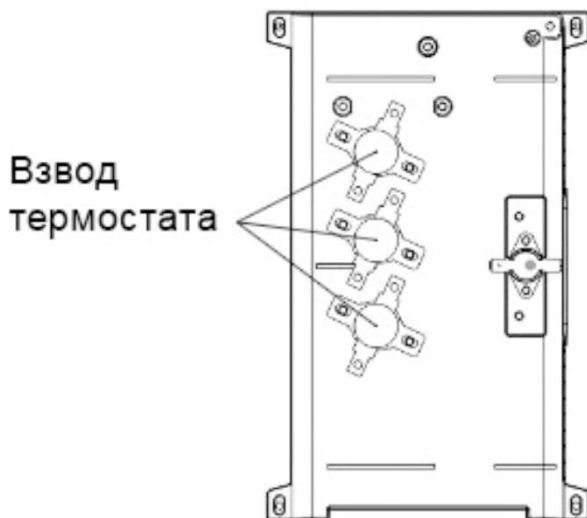
Рис. 18. Ручное восстановление термостатов
